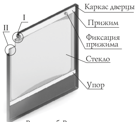
Рисунок 5. Ремонт светорозрачного экрана двери
